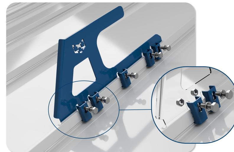
Установите крюк безопасности PP ROLLED с обратной стороны фальцевого замка и закрепите с помощью пяти фальцевых планок и метизов. Рекомендуемая затяжка болта - 9,5 Нм.
