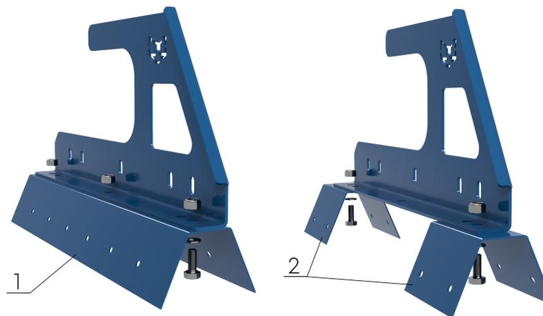
Болт М8х20 / Шайба М8 / Гайка самоконтрящаяся М8 - 3 шт.
