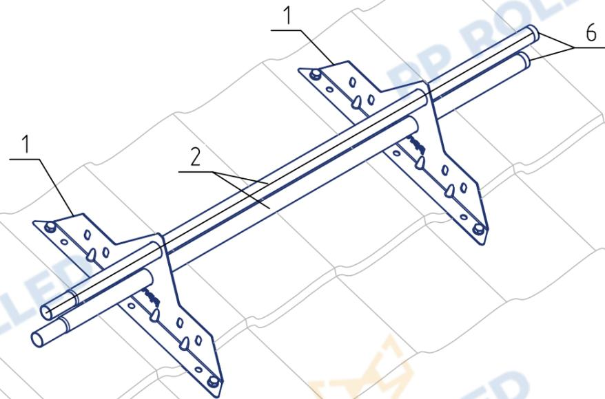
Типовой узел крепления снегозадержателя на металлочерепицу
